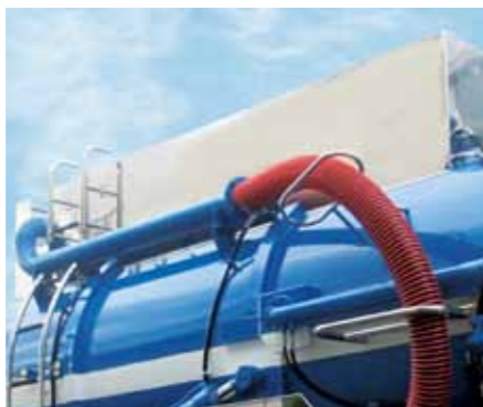
タンク上部シェルター
