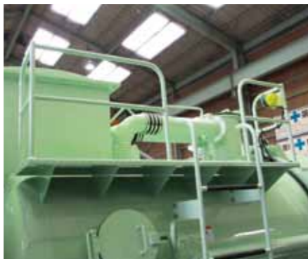
タンク上部足場
